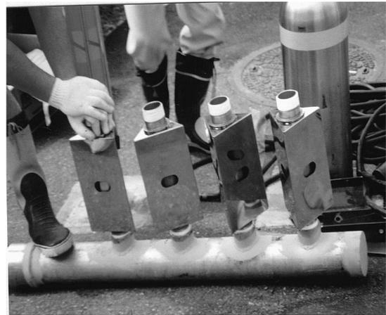
写真7. ジェット噴射装置エカローマシン
